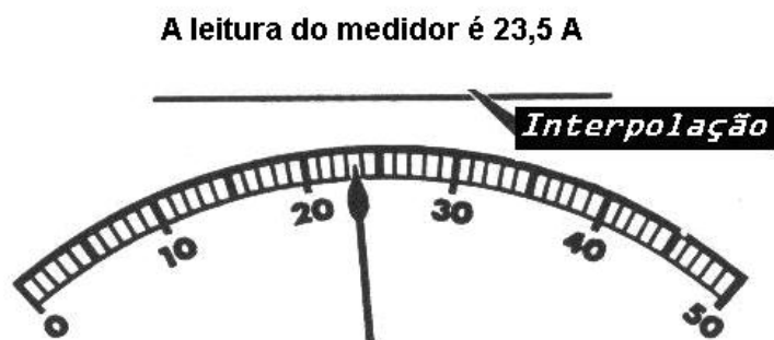
Figura 2: Leitura de amperímetro com 3 algarismos significativos.
